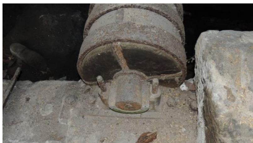
Vlevo detail spoje dvojdílného velkého převodového kola, vpravo detail kluzného ložiska hnacího hřídele
