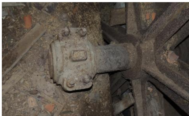
Vlevo detail spoje dvojdielného velkého převodového kola, vpravo detail kluzného ložiska hnacího hřídele
